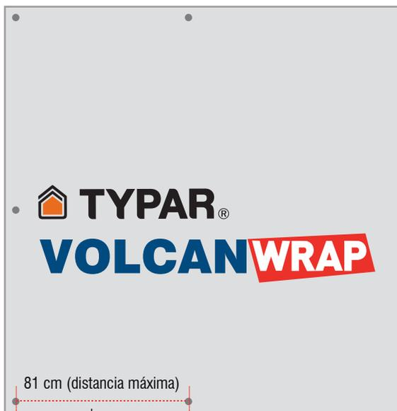
Clavos con cabeza plástica (madera como estructura de apoyo) o tornillos (metal como estructura de apoyo, con golilla metálica o plástica). En ambos casos a 81 cm (distancia máxima) entre uno y otro.
