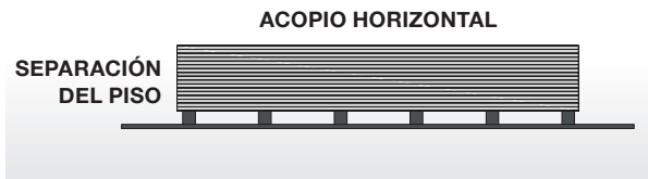
Figura 7.5. : Cuidados en el almacenamiento de listones y perfiles para el entramado (Fuente: CDT).
